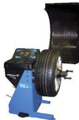
Балансировочный стелд для малых шиномонтажных мастерских и мобильного шиномонтажа.
