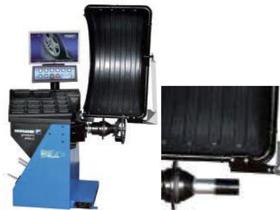
**Балансировочный стенд с ЖК дисплеем для мастерских с малым и средним объемом работ по обслуживанию шин.**
