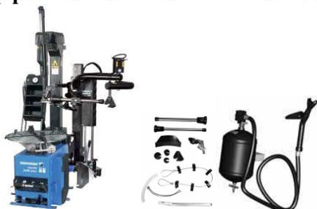
Двухскоростной (7 и 13 об/мин) автоматический шиномонтажный станок для колес шириной до 16" , с зажимом снаружи до 26"
