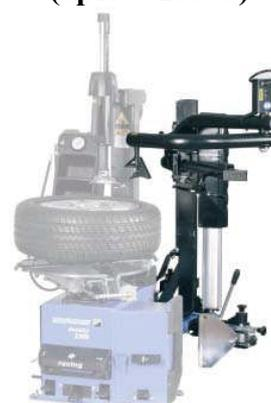
Устройство МН 320 рго незаменимо при монтаже и демонтаже низкопрофильных шин и шин gun flat со свойствами безопасности
