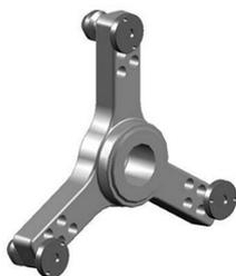
3-х лучевая центрирующая звезда. Центрирование колес грузовых автомобилей по болтовым отверстиям, расположенных на окружностях с диаметрами 170/184,15/205/222,25/245мм
