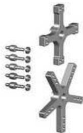
**Комплект зажимов Professional.** Профессиональный зажимной комплект для колес грузовых автомобилей (4-х и 5-ти лучевые центрирующие звезды, 5 пальцев). Центрирование колес грузовых автомобилей по болтовым отверстиям, расположенных на окружностях с диаметрами 10x335/10x285/10x225/8x275/8x285мм
