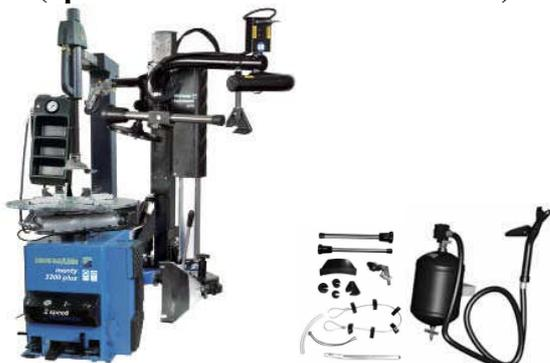
Автоматический 2х скоростной (7 и 13 об/мин) шиномонтажный станок с зажимом до 24"
