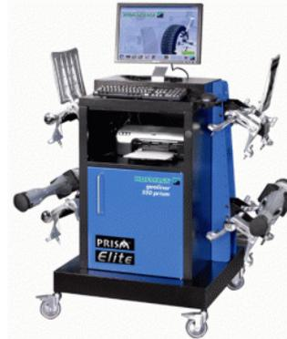
В приборе geoliner 580 prism используется технология контроля углов установки колес, сочетающая свойства технологий CCD и 3D.
