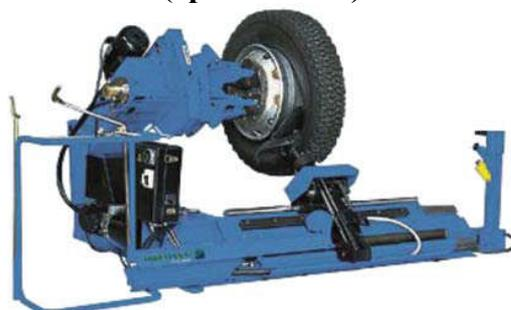
Шиномонтажный станок для монтажа и демонтажа грузовых шин, сельскохозяйственных и строительно-дорожных машин и OTR-колес диаметром обода 14" – 44", 2е скорости вращения 4 и 8 об/мин.
