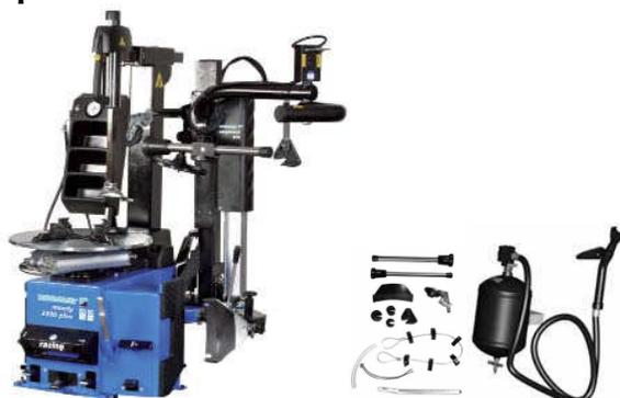
Автоматический шиномонтажный станок для колес шириной до 14" , зажимом до 24" и 2мя скоростями вращения стола (7 и 13 об/мин)
