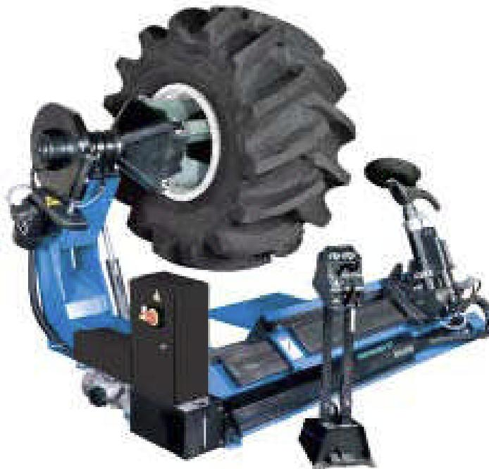
Универсальный шиномонтажный станок для колес с диаметром ободьев 4" – 58", 2-мя скоростями зажимного устройства и усилием отжима до 4х тонн.
