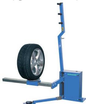
Универсальный подъемник колеса для балансировочного стенда, обеспечивает подъем колеса на высоту центра главного вала балансировочного стенда, что обеспечивает точность центрирования и крепления колеса на стенде.
