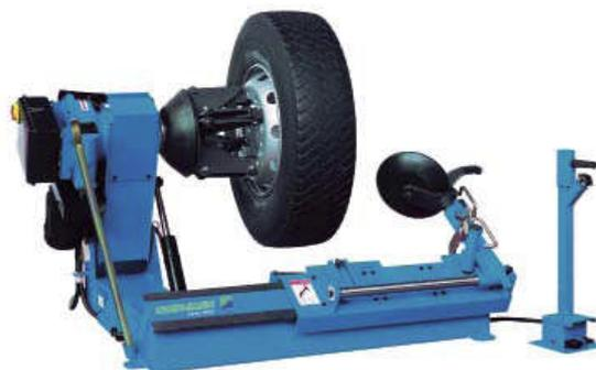
Шиномонтажный станок для монтажа и демонтажа камерных и бескамерных грузовых шин с монтажным ручьем и замковым кольцом до 26"
