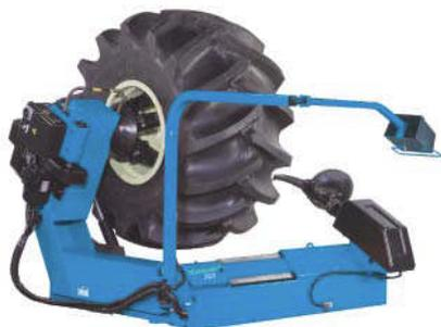
Шиномонтажный станок для монтажа и демонтажа грузовых шин, сельскохозяйственных и строительно-дорожных машин и OTR-колес диаметром обода 14" – 32", 2е скорости вращения 4 и 8 об/мин.
