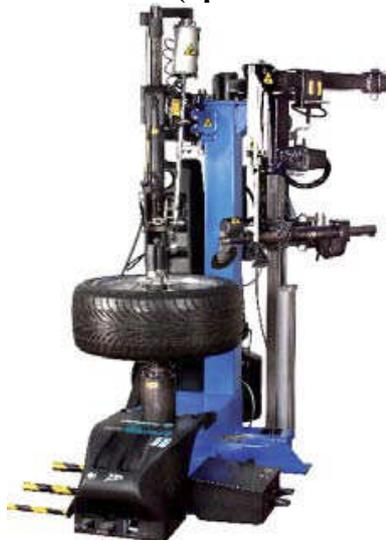
Полуавтоматический шиномонтажный станок для всех типов шин, включая низкопрофильные шины UHP и „безопасные“ шины gun flat не используя монтажную лопатку
