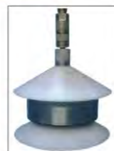
Просверлить два диаметрально противоположных отверстия Отогнуть сепаратор Ввести захваты. Провернуть на 90° для фиксации. Для выпрессовки подшипника используется винт.
