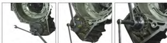
Нажать для снятия хомута Снять втулку. Установить сальник.
