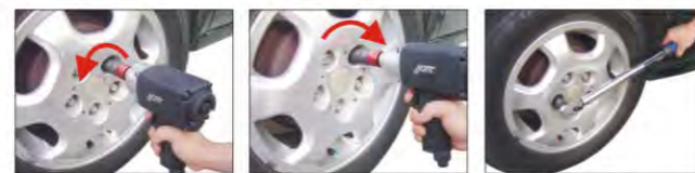
а. Открутить колесные гайки с максимальным крутящим моментом гайковерта. б. Зафиксировать колесную гайку в головке. Используя гайковерт, закрутить гайку с заданным усилием. в. С помощью динамометрического ключа убедиться, что гайка закручена с требуемым усилием.
