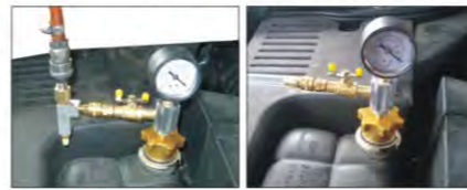
вакуумная откачка воздуха замена жидкости в радиаторе
