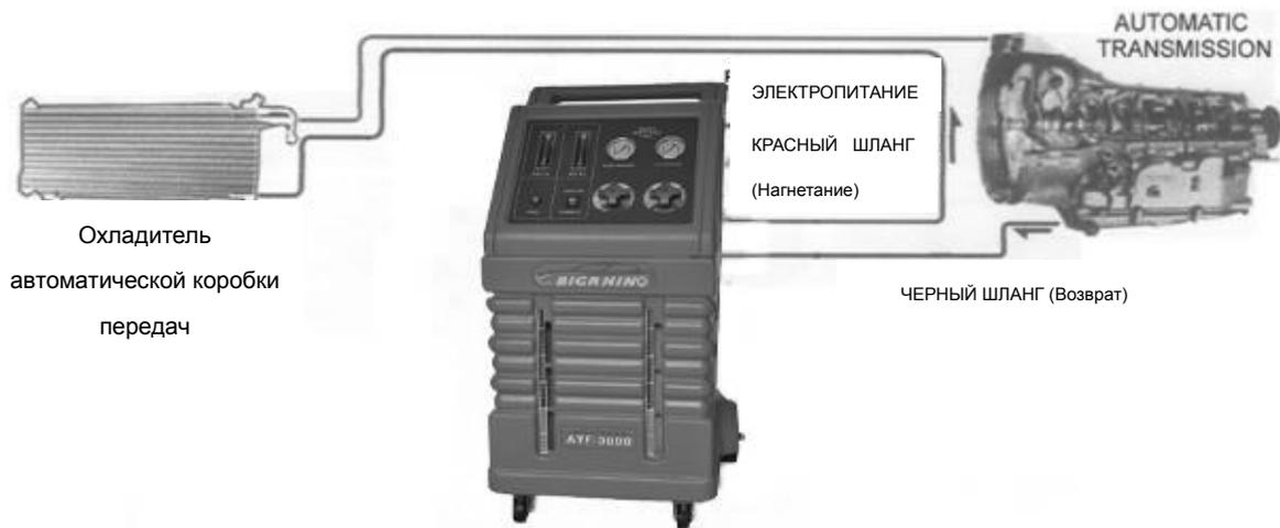
7. В ходе процесса следите за расходом нового и отработанного масла. Скорость их тока должна быть одинаковой. Если отработанное масло вытекает быстрее нового, отрегулируйте шаровой клапан на черной возвратной линии, чтобы уравнивать расход.
